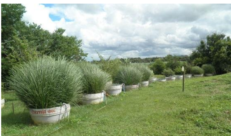
Figura 1: Vista geral dos doze módulos de tratamento do sistema de tratamento de esgoto por alagados construídos, em 15 de dezembro de 2011 (198 dias após o início da aplicação do esgoto).
