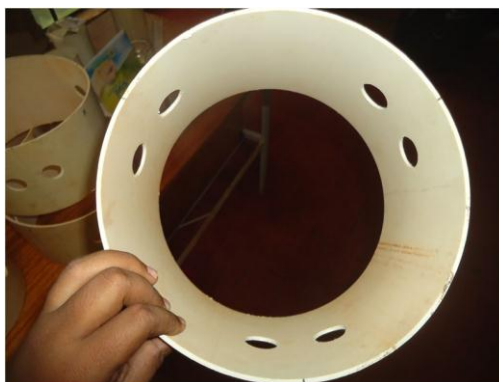
Figura 1: tubo de PVC com diâmetro de 250 mm, perfurado para a fixação dos elementos flutuadores (garrafas PET de 2 litros).
