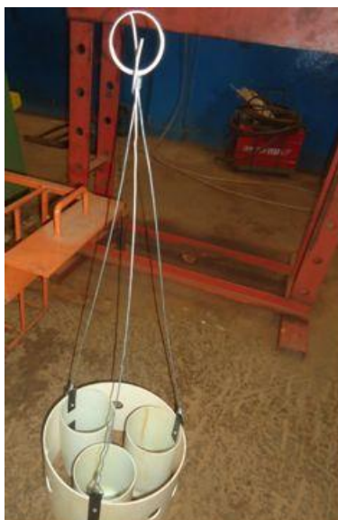
Figura 4: gancho de três pernas de arame galvanizado utilizado para pendurar o flutuador.
