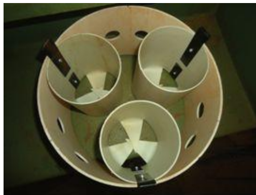
Figura 3: detalhe da fixação dos recipientes de cultivo do capim Vetiver ao suporte do flutuador, arrebitados em fitas de aço.
