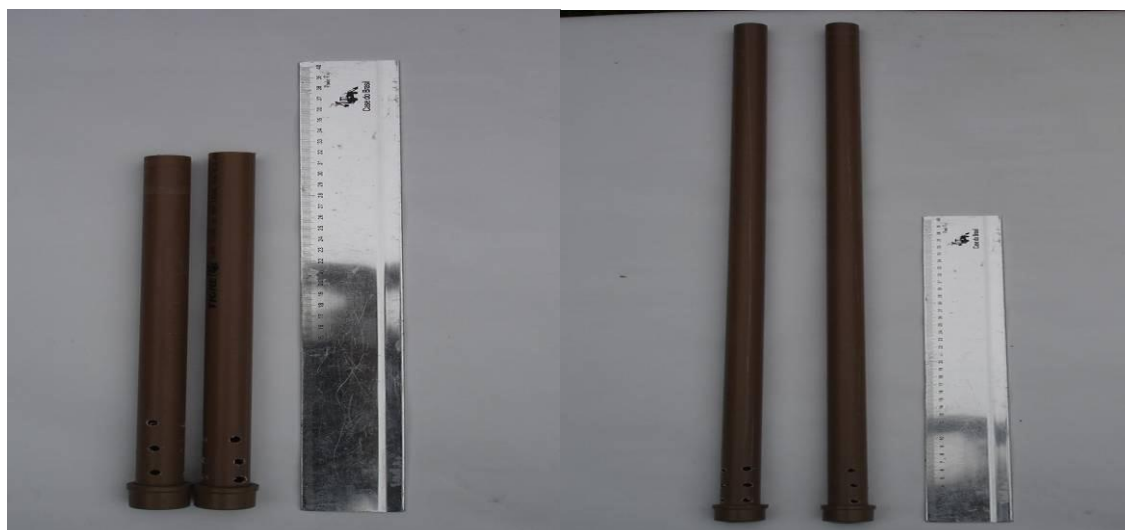
Figura 2: a esquerda tubos com 30 cm de comprimento para coleta de amostra na interface zona de raízes-brita; a direita tubo de 70 cm de comprimento para coleta de amostras no filtro de areia.
