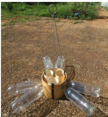
Figura 5: vista geral do flutuador desenvolvido para pesquisas com capim Vetiver em lagoas de tratamento de esgoto.
