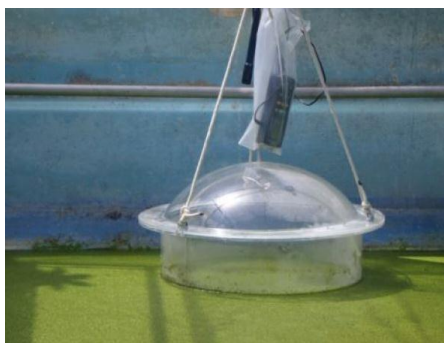
Figura 2. Câmara de fluxo utilizada para monitoramento da fase gasosa.
