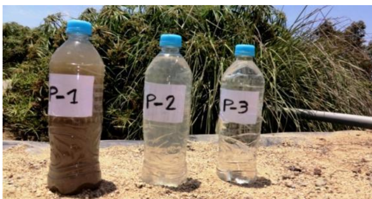
Figura 10: Amostras de esgoto bruto (P-1), efluente da primeira etapa (P-2) e efluente da segunda etapa (P-3).
