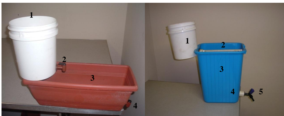
Figura 01: Descrição ilustrada da montagem de um sistema piloto de LCFSH. 1. Recipiente de armazenamento da vinhaça, 2. Torneira de alimentação do sistema. 3. Leito para crescimento das macrófitas, 4. Torneira de Coleta.
