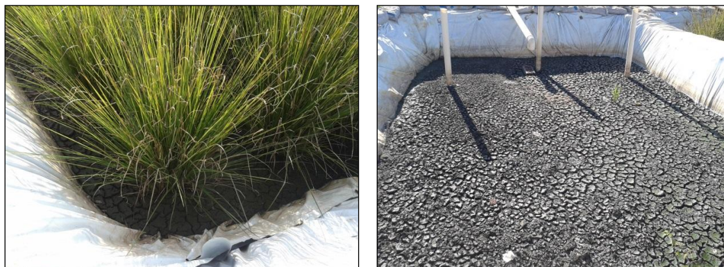
Figura 4 Imagem representativa de ambos os leitos de tratamento com destaque para o lodo acumulado após diversas aplicações de RS.
