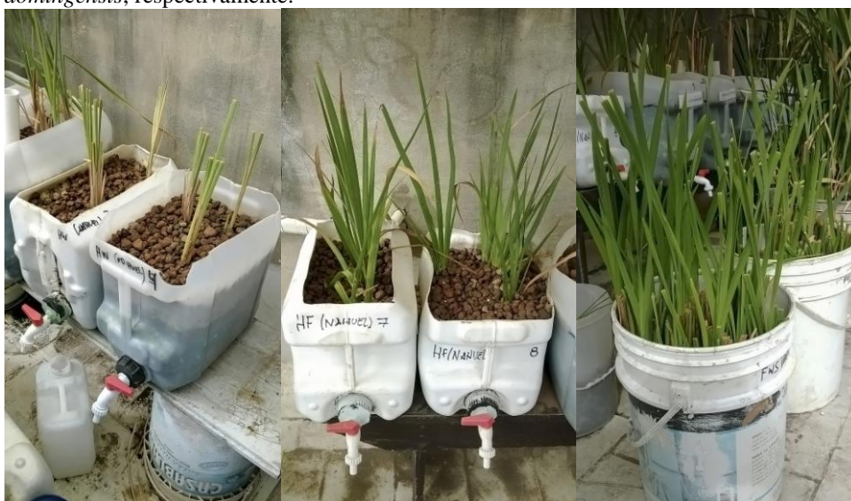
Figura 1. Wetland Sub-superficial horizontal com T. domingensis , I. pseudacorus e wetland superficial com T. domingensis , respectivamente.
