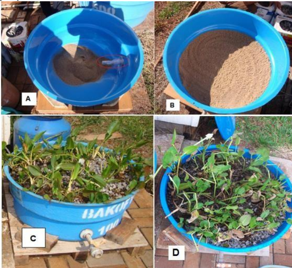
Figura 1 – Montagem do sistema piloto de wetland . A – Detalhe do cano de coleta; B – Colocação dos meios suportes (areia e brita); C – Piloto pronto, com os meios suportes e as macrófitas; D – Detalhe da macrófita aquática Pontederia parviflora .
