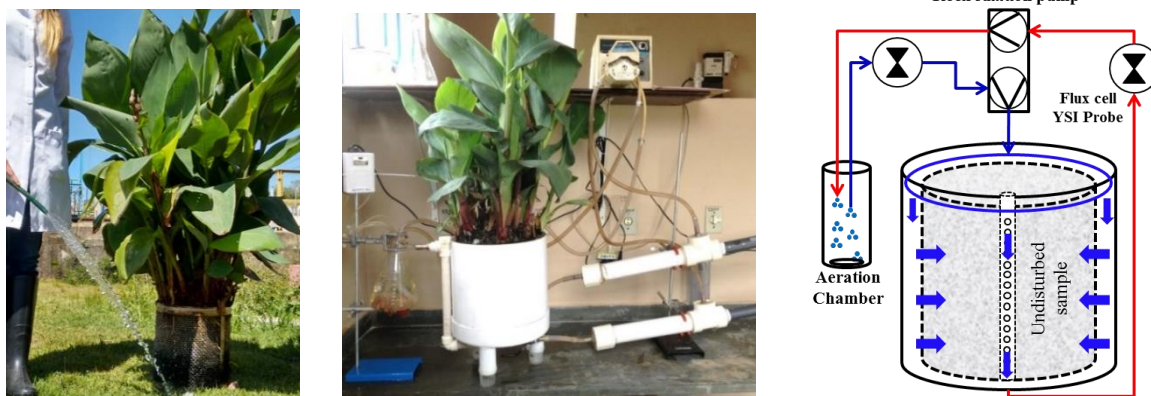
Figura 1: Foto da amostra indeformada removida do leito (esquerda); Foto da instalação experimental completa (centro); Vista esquemática do sistema do respirômetro (direita).
