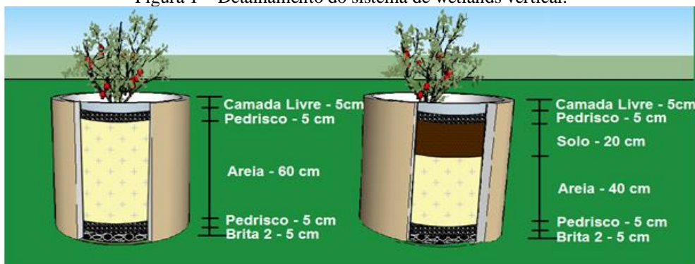
Figura 1 – Detalhamento do sistema de wetlands vertical.
