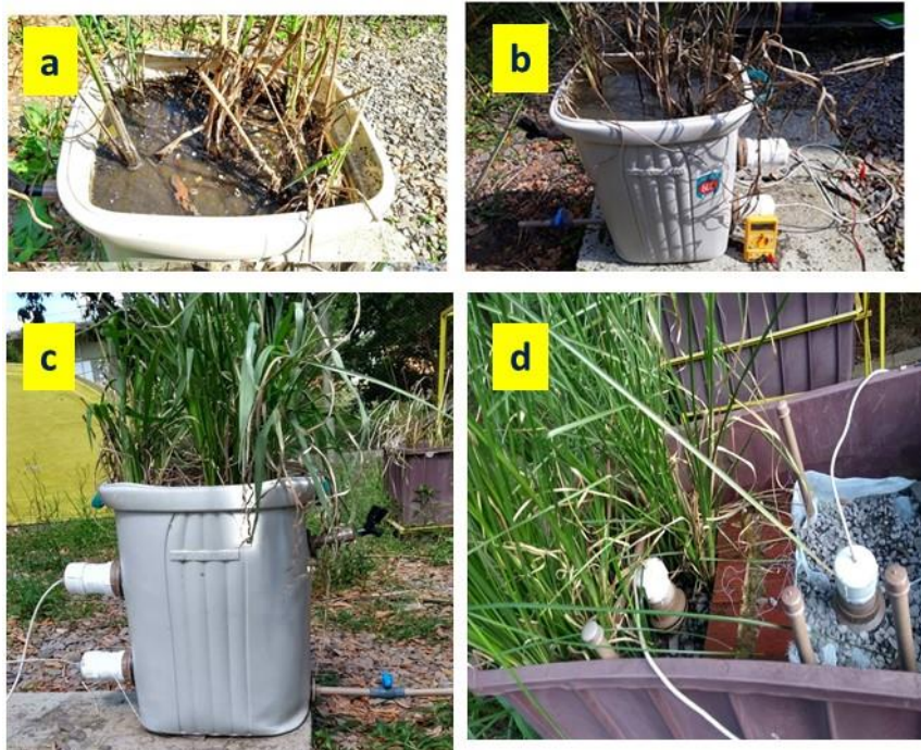
Figura 2 - Aspectos de acolmatação com as mudas de Hymenachne grumosa - Carnivão (a e b); Desenvolvimento com o Vetiver e Sistema WCFSS/CCM + WCFV COM Vetiver e Carnivão.
