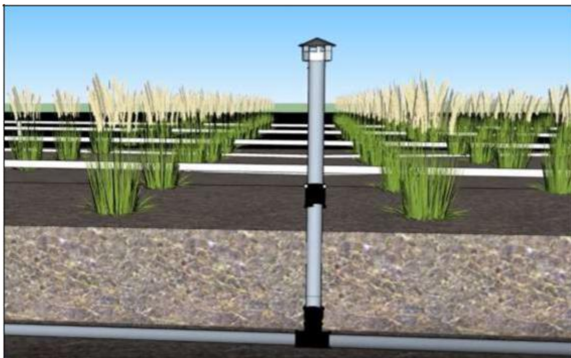
Figura 13: Detalhamento das chaminés de amostragem instaladas nas lagoas do HC
