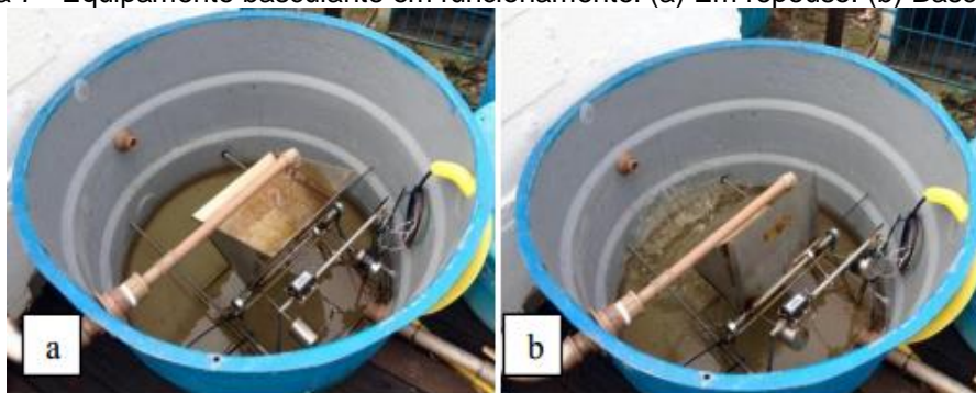
Figura 7 - Equipamento basculante em funcionamento. (a) Em repouso. (b) Basculando.
