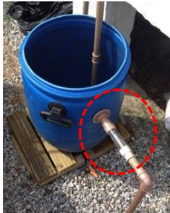
Figura 6 - Dispositivo para medição de vazão de entrada (pós bombeamento) nos módulos WC.
