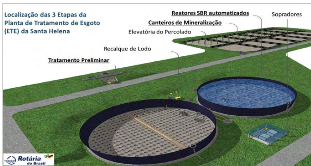
Figura 1: Localização de cada etapa de tratamento da ETE Santa Helena com aproveitamento da última lagoa do sistema existente como canteiro de mineralização de lodo
