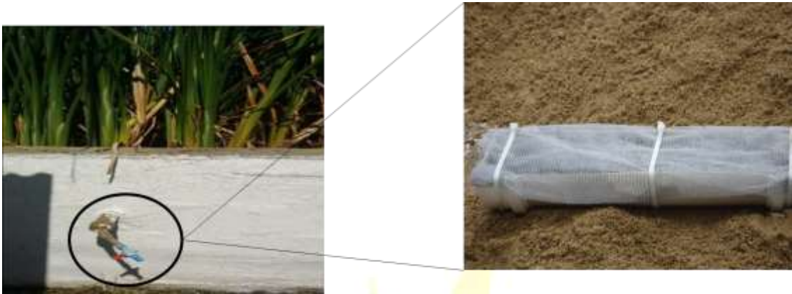
Figura 2 - Implantação de amostradores em ponto intermediário no Wetland construído vertical de fundo saturado
